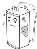
Nieprawidłowe odprowadzanie ciepła, sprawdź, czy wokół urządzenia jest wystarczająco dużo miejsca.
